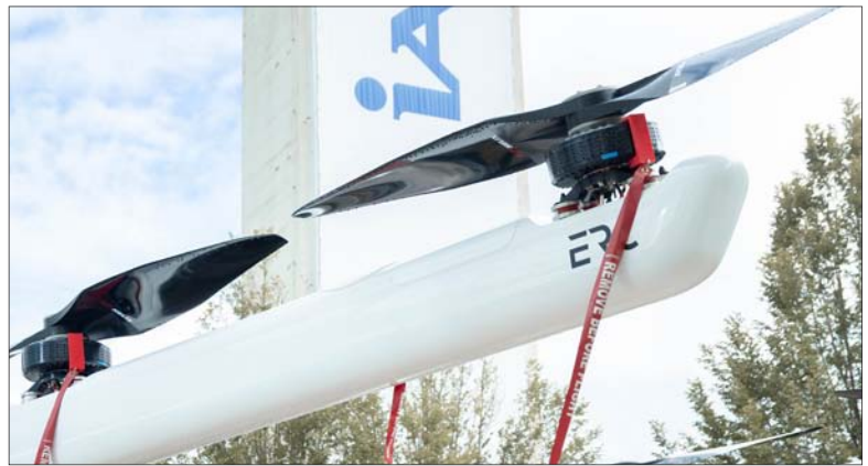
升力螺旋桨的尺寸很大以降低这架 3 吨重的飞机的噪音
