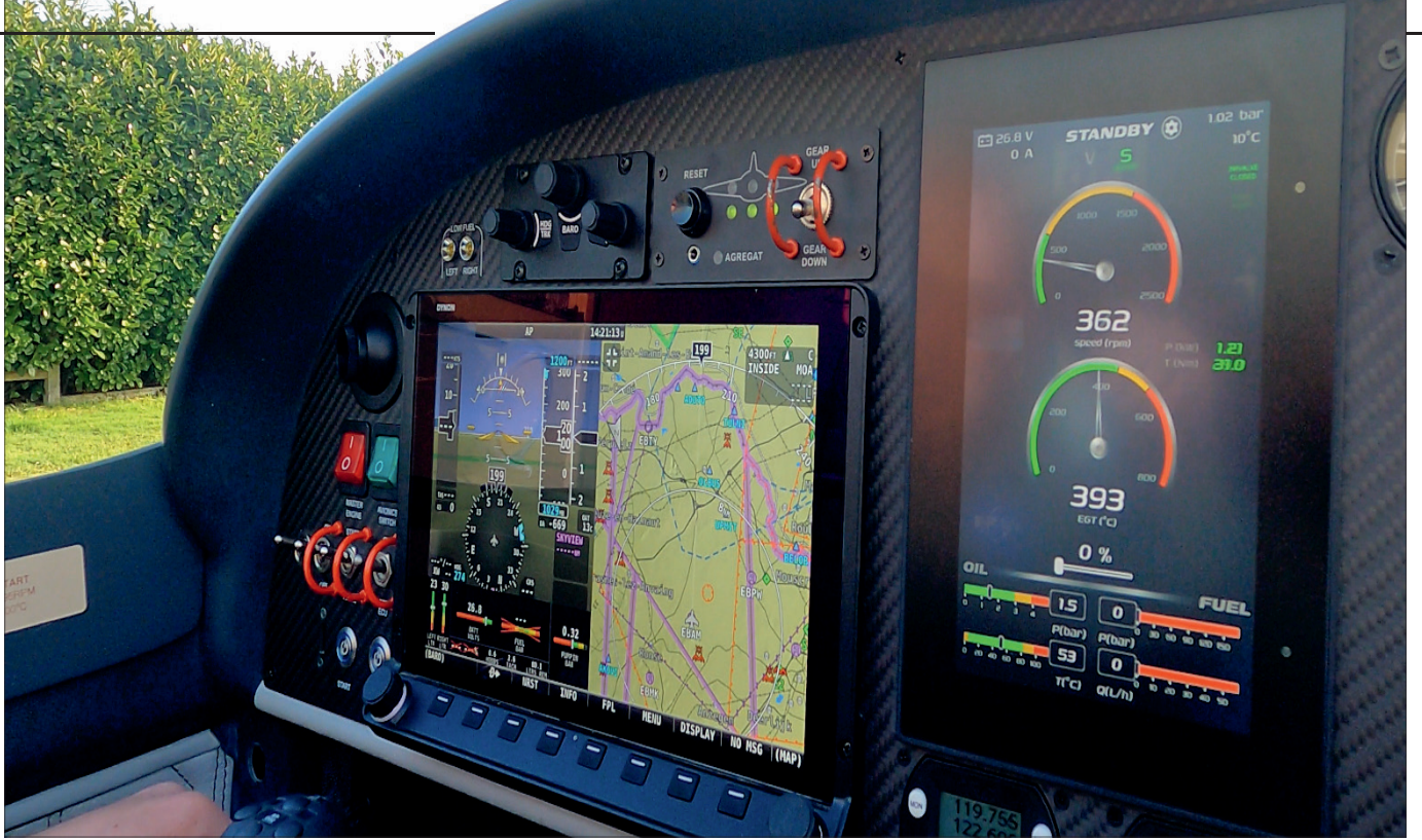
仪表板允许安装整个玻璃驾驶舱。此处显示的此版本不是最终版本，仅在测试阶段结束之前使用。将来，将直接显示涡轮机参数显示在 Dynon。
