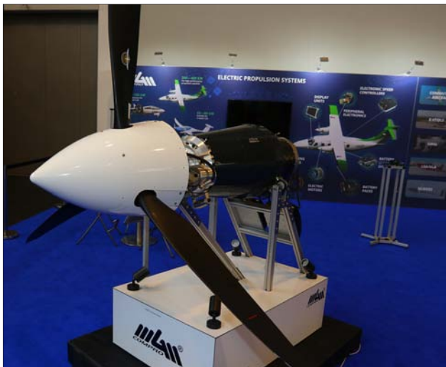
MGM Compro 公司 的可替代 PT6 的电机
