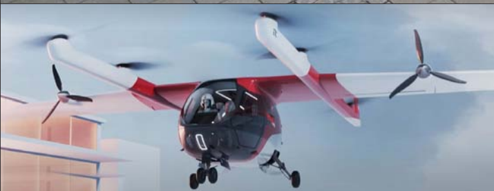
ERC 的设计有 8 个升力桨和 2 个巡航桨，原型机亮相时还没有安装巡航桨。
