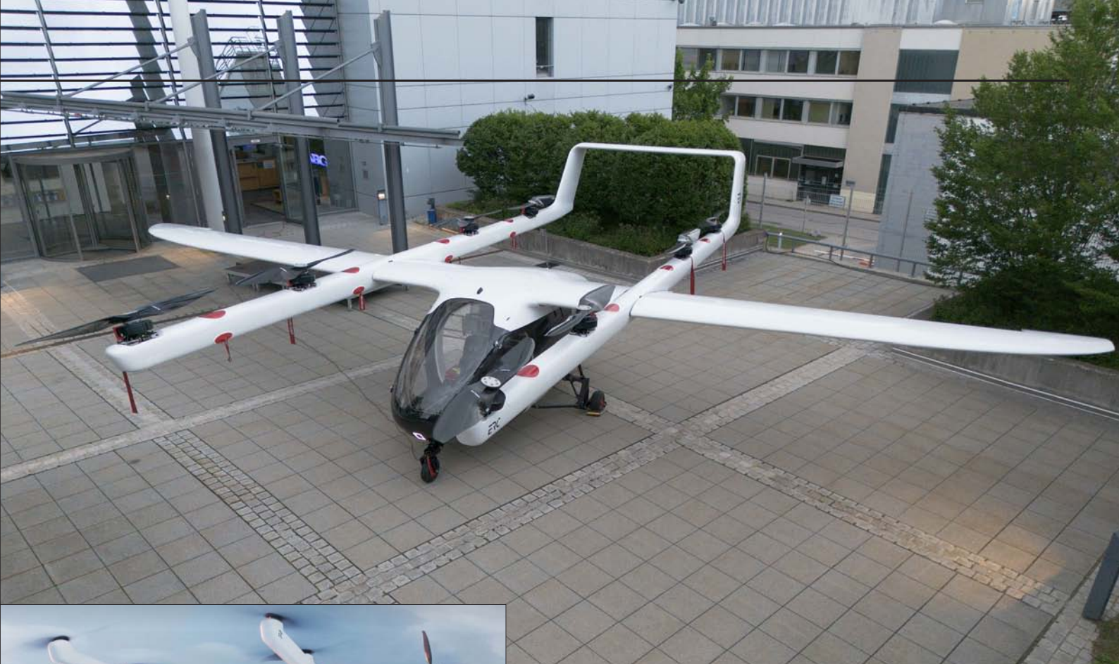
ERC 的设计有 8 个升力桨和 2 个巡航桨，原型机亮相时还没有安装巡航桨。
