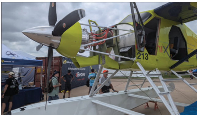
Magni-X 不仅在 Airventure 的主要飞机展示区展示了其 e-Beaver 电动改装水獭飞机（由温哥华港湾航空运营），还在温尼贝戈湖的水上飞机基地展示了该机的实际操作。
