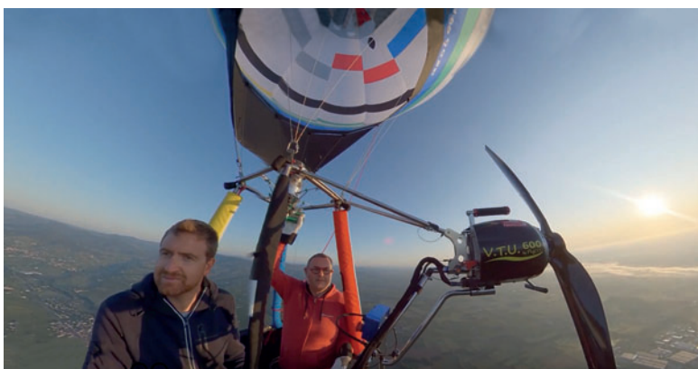
借助可矢量偏转的电动螺旋桨，热气球可以变身成为轻型运动类热气球飞艇。
