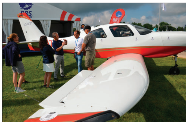
LX7 Aircraft Co. 将 Lancair IV 改装成超高性能 4 座飞机，配备 Continental TSIO-550-E 活塞发动机或 PT-6 涡桨发动机。与 Cirrus 系列一样，这架飞机也配备了 BRS 整机弹射救生伞。
