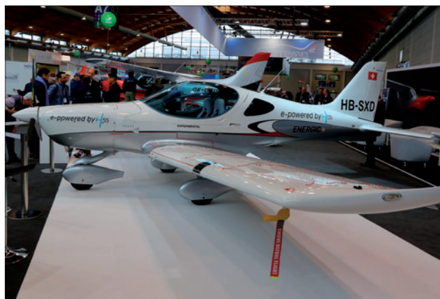
Bristells公司的B23 Energic公司使用一台H55公司研制的航空电机，该机正在申请23部适航证。
