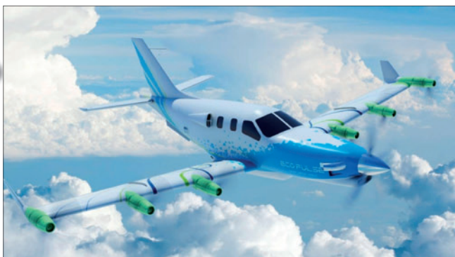
Dahers公司的Eco Pules验证机基于通航飞机改装，在原来的PT6涡桨发动机以外，在机翼上加装了分布式电推动力。
