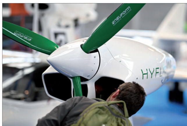
HyFly公司正在研发适用于超轻机和动力滑翔机的氢燃料电池电推动力系统。
