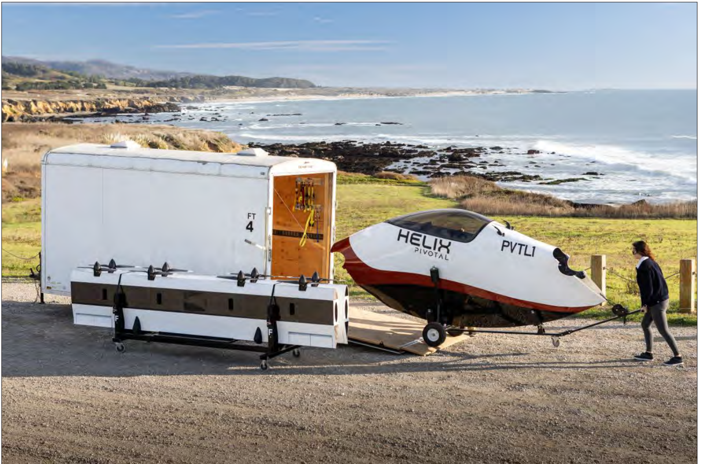
Helix 的机翼可以快速拆装后装入专用拖车方便运输。
