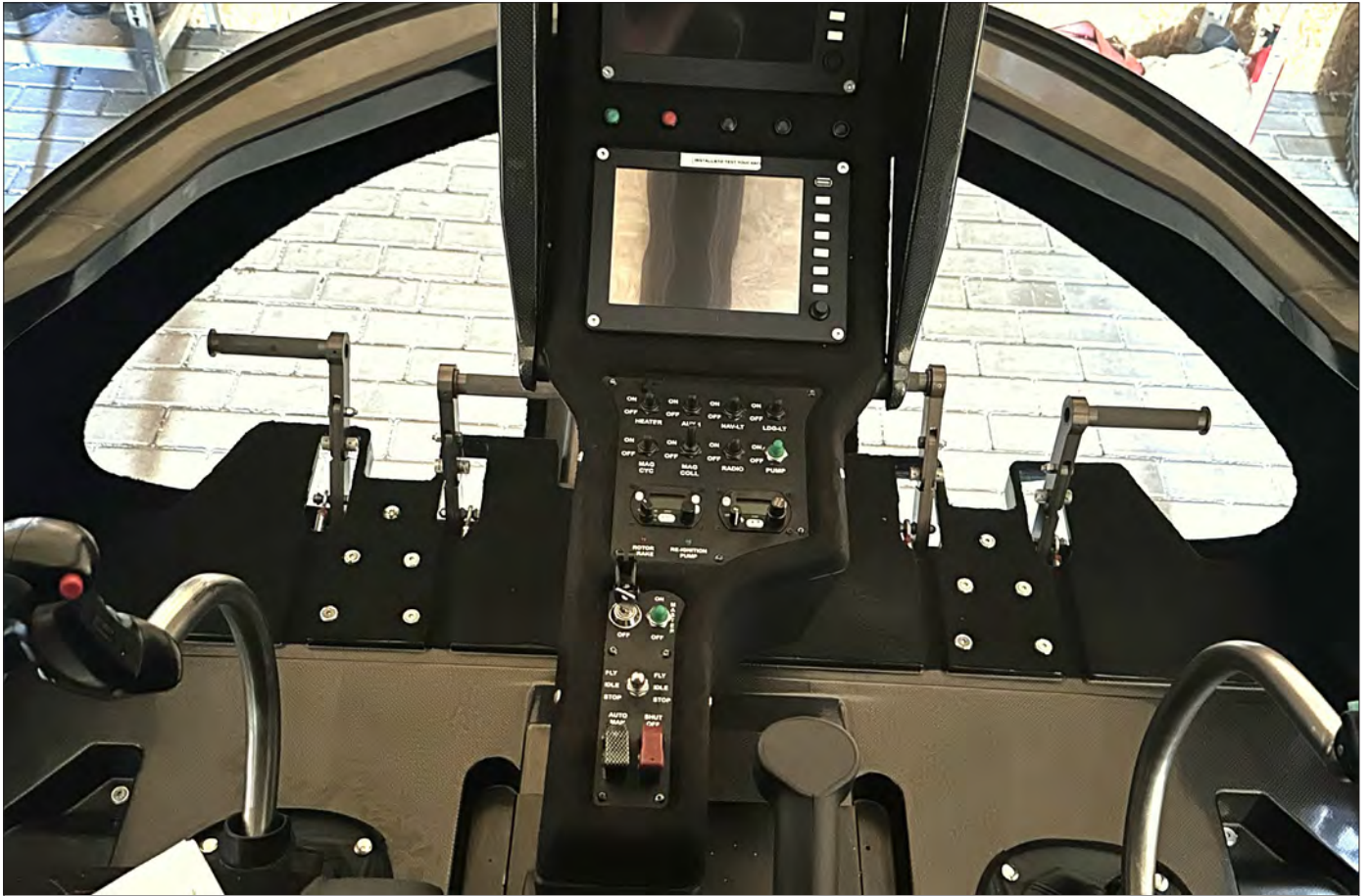
多功能显示屏在布局清晰的仪表板上占据主导地位。仪表盘的排列方式既便于观察，又不会影响全方位视野。
