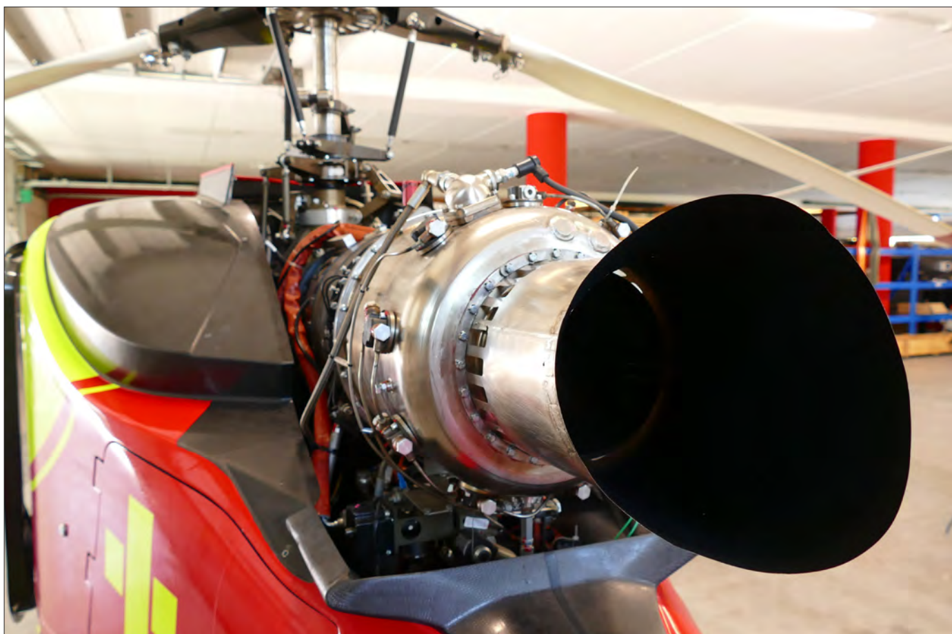
自主研发的 TK 250 径向涡轮可产生超过 250 hp 的功率。不过，K1 的启动功率被电子限制在 190 马力。
