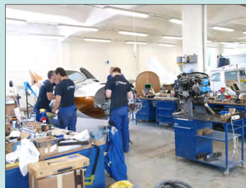
在这里，915 iS 发动机被安装在飞机上
