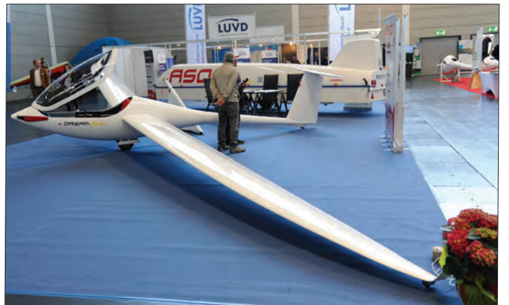
来自意大利的 ASO 公司去年首次推出的 UL 滑翔机 Dream Glider 在机头上带有折叠螺旋桨，令人惊讶。与此同时，由沃尔特·毛里 (Walter Mauri) 开发的该机已经完成了首飞。据说在 85 公里 / 小时时的滑翔比为 44。
