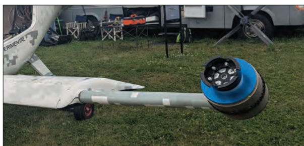
撑杆上的电机可防止翼端出现边缘涡流。
