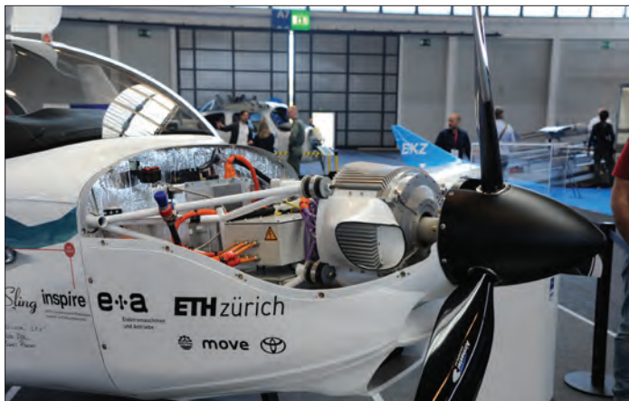
e-Sling 是一款来自南非的下单翼全金属飞机，已在瑞士苏黎世联邦理工学院 (ETH) 的一个项目中实现电气化，并已成功升空。许多组件都是在瑞士大学本身开发的。
