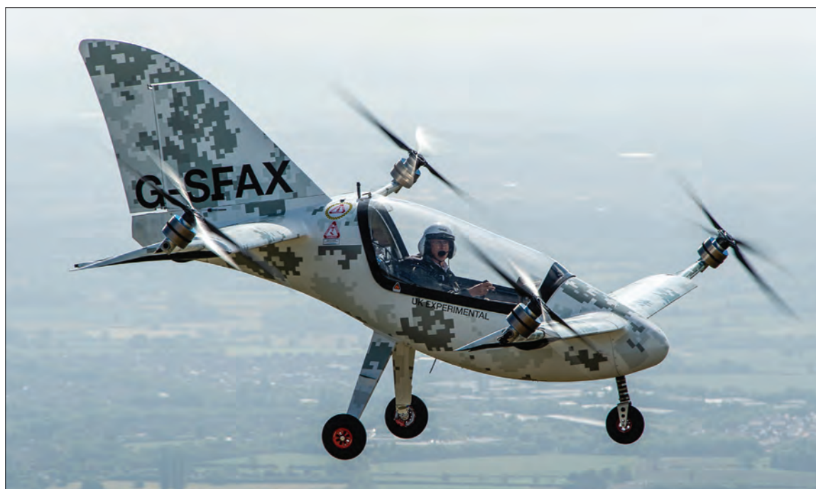
英格兰上空的不寻常景象。大尺寸方向舵确保了良好的纵向稳定性，尽管很短。
