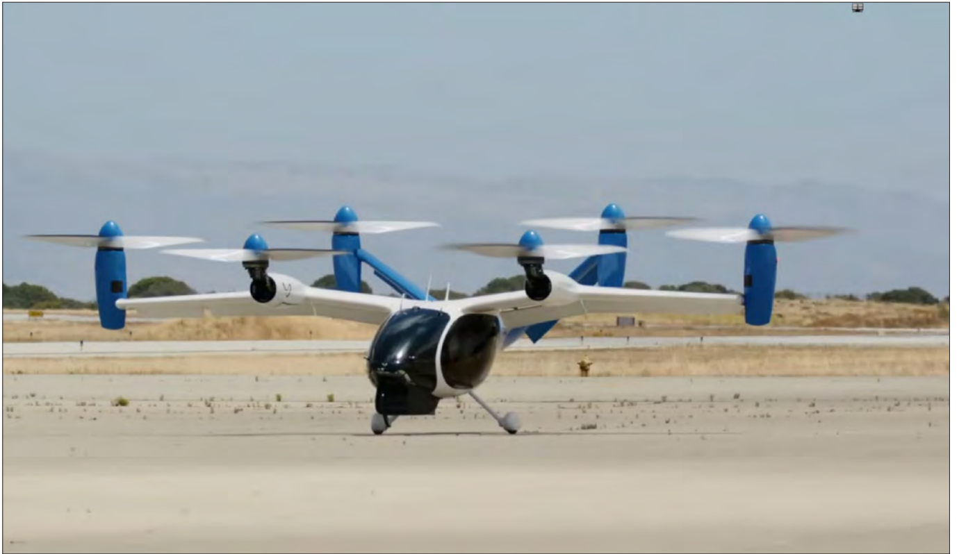
Joby 使用锂电池的 eVTOL 型号正在进行 FAA 适航审定，在创纪录飞行中，加装了氢燃料电池和一个液氢储氢罐。
