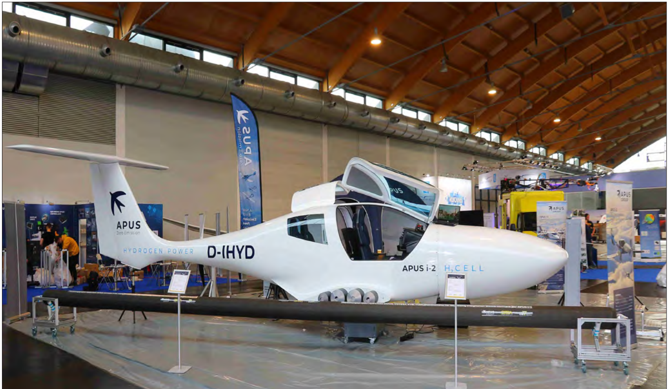
来自的 APUS 公司是氢能航空领域的先锋，他们首个验证机是一架双发电驱飞机，针对转场和飞行培训市场设计。该公司将申请 23 部适航审定。该机使用两台电机和氢燃料电池。该机最大的特点是高压氢气罐是与圆柱形的机翼翼梁整合为一体的。
