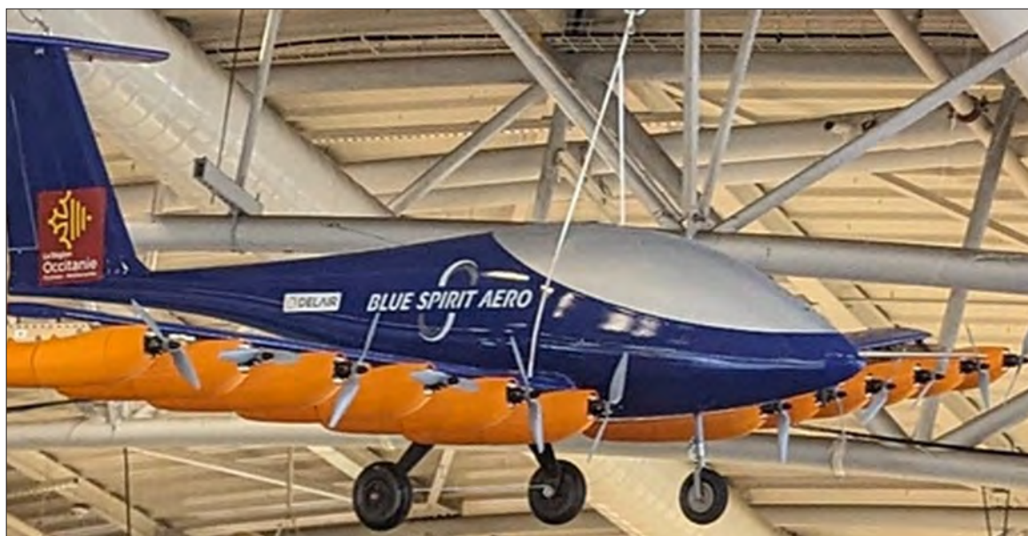
法国 Bluespirit 公司研制的电动飞机针对飞行培训市场，使用 10 个电机，每个电机都有配套的燃料电池堆栈。
