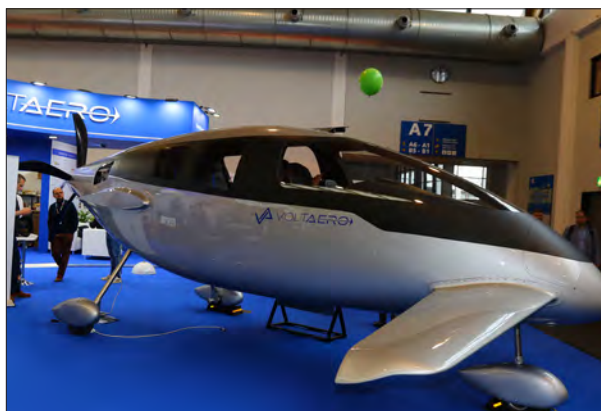
法国 VoltAero 公司的 Cassio 330 混动电推飞机采用的川崎内燃发动机作为发电机，该发动机也可以直接使用氢气作为燃料。
