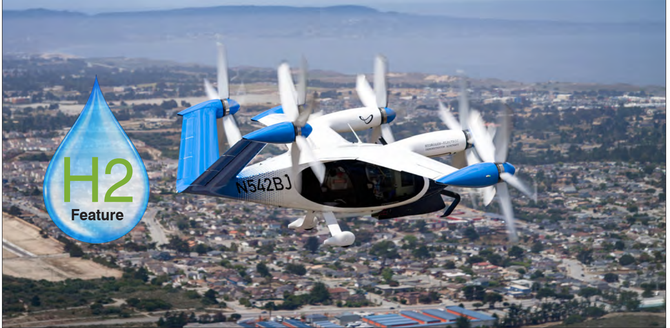
Joby 在 2024 年 7 月进行的令人吃惊的创纪录飞行使用了由 H2Fly 公司研制的液氢燃料电池堆栈
