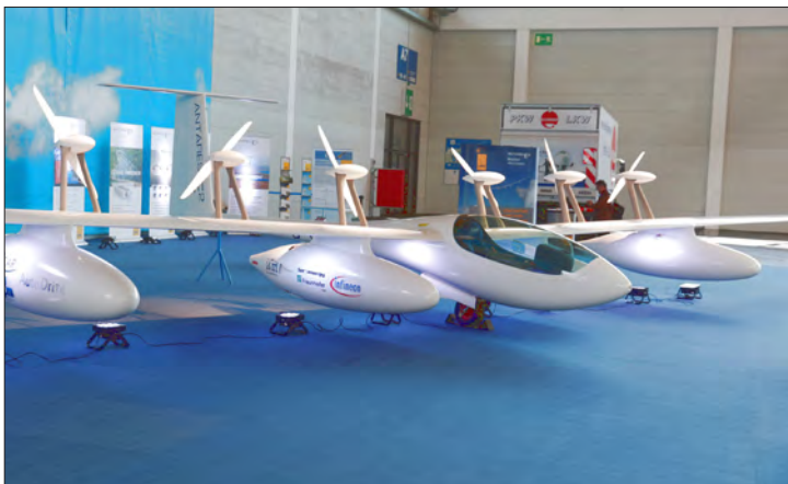
Lange Research 公司研制的基于该公司已经取证并交付的电推自升空滑翔机的氢燃料电池无人机。
