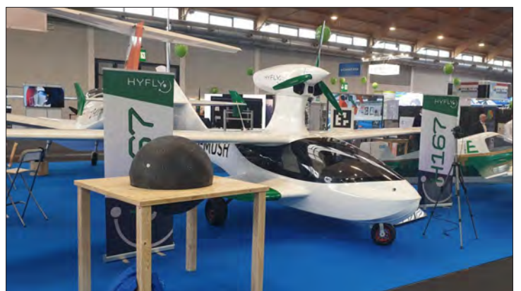
德国 HyFly 公司研制的使用氢燃料电池电驱改装的小型水陆两栖飞机。
