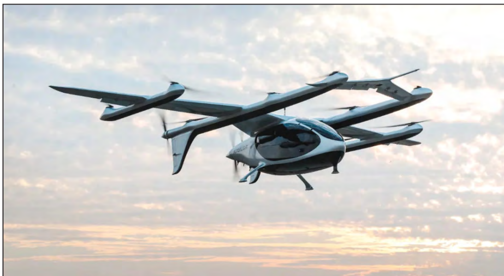
盛世龙 eVTOL 为五座，最大载重 2.2 吨，最大航程 250 公里，巡航速度可达 200 公里每小时。
