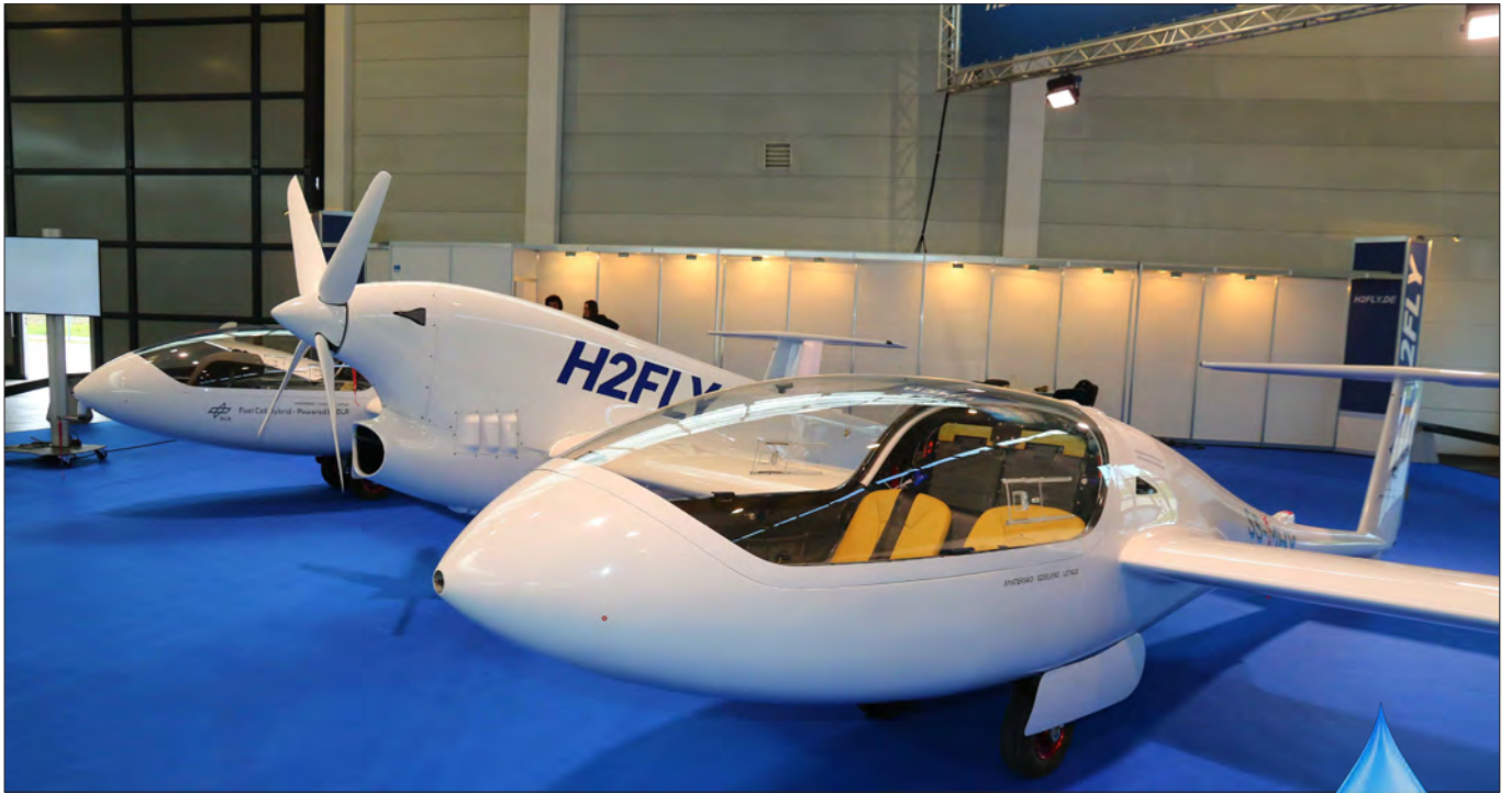
H2Fly 公司研制的 HY4 飞机创造了多项世界纪录，是全球首个使用液氢燃料电池的四座飞机。
