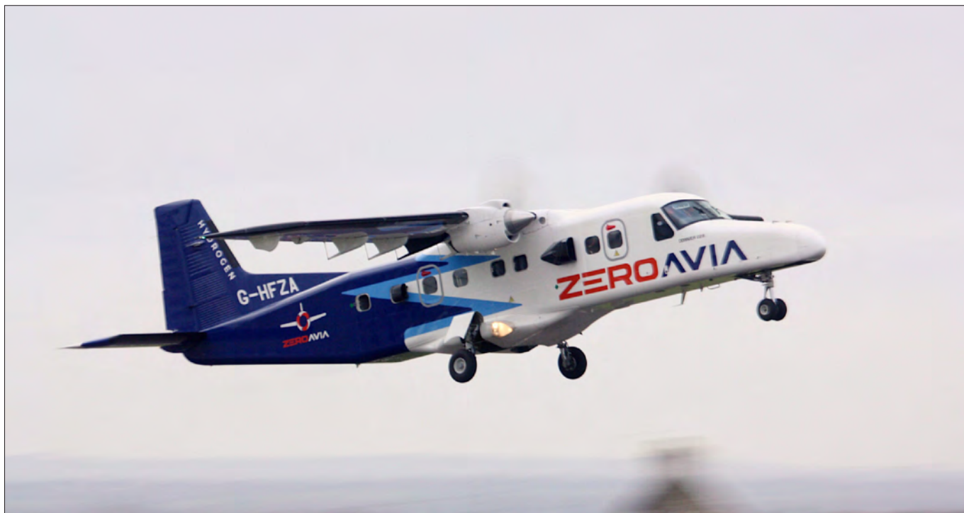
美国 ZeroAvia 改装的这架道尼尔 Do228 支线飞机更换了一台使用氢燃料电池的电机，该公司在研发针对更大型飞机的氢能电推进动力系统。
