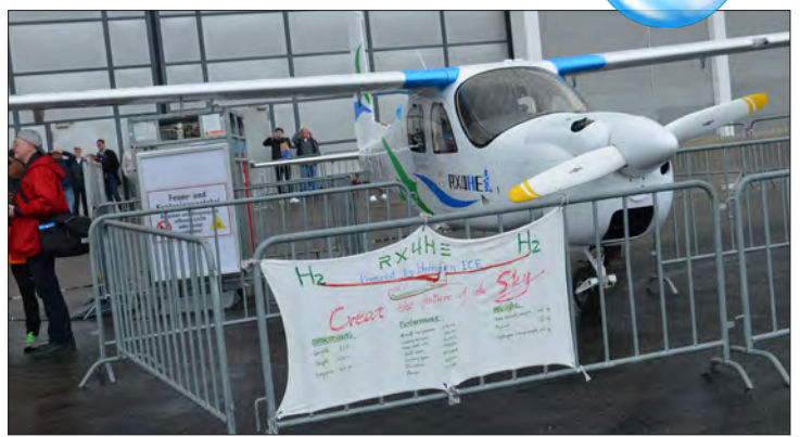
基于锐翔 RX4E 电动飞机的验证机改装使用了一台直接使用氢气作为燃料的内燃发电机
